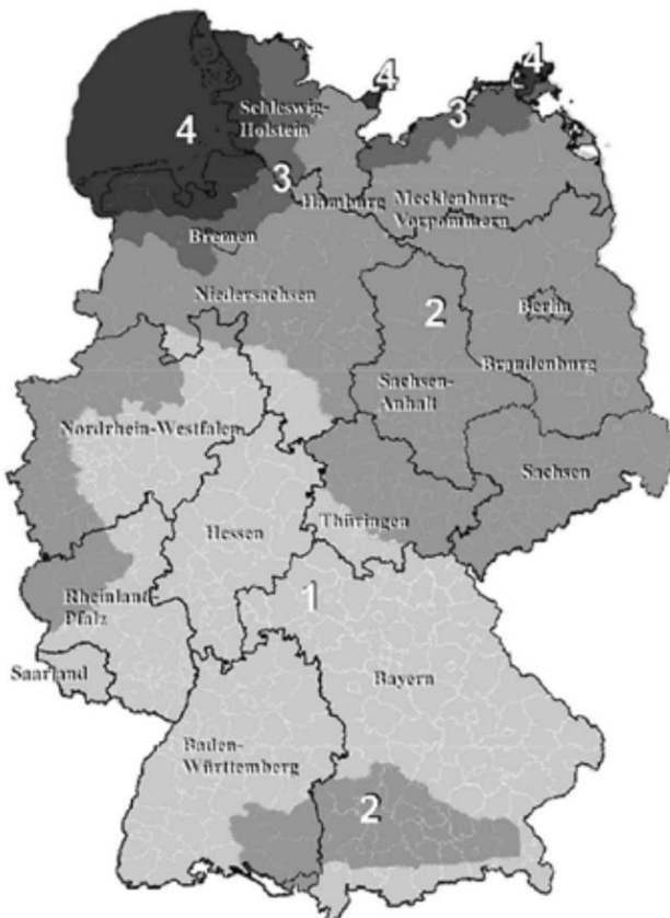
Bild 2 Windlastzonen Deutschland nach DIN EN 1991-1-4/NA
