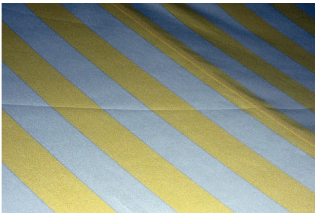
Image 9.1.18 Plis de manipulation d'origine technique dus au transport ou au montage
