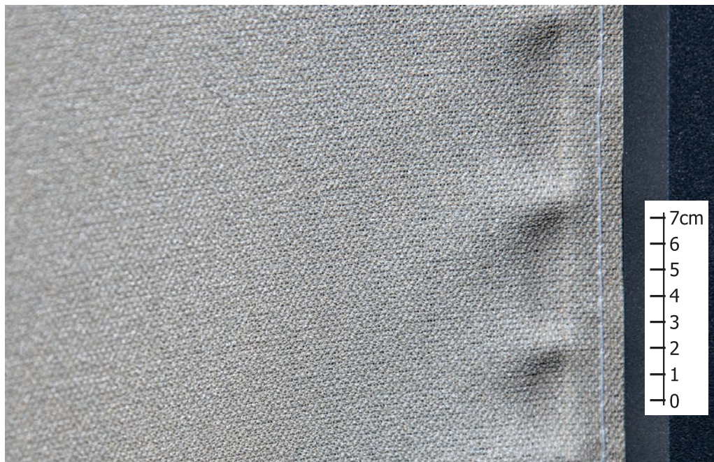
Image 9.4.1 Formation admissible de plis possible sur installations ZIP au niveau des ourlets latéraux (transition avec la fermeture éclair)
