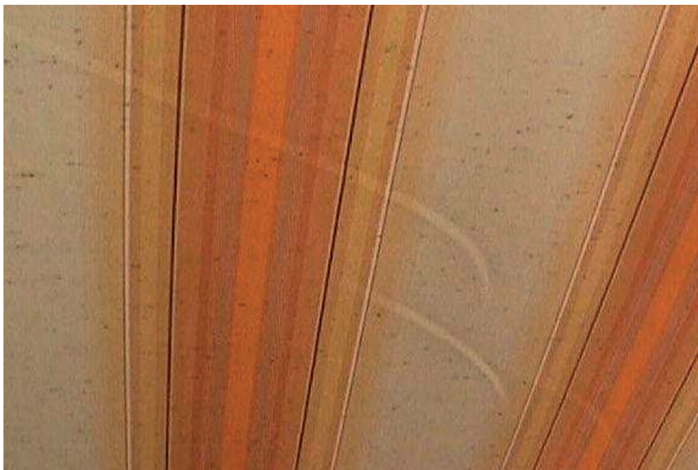
Image 9.1.13 Représentation de superposition de plis d'enroulement
