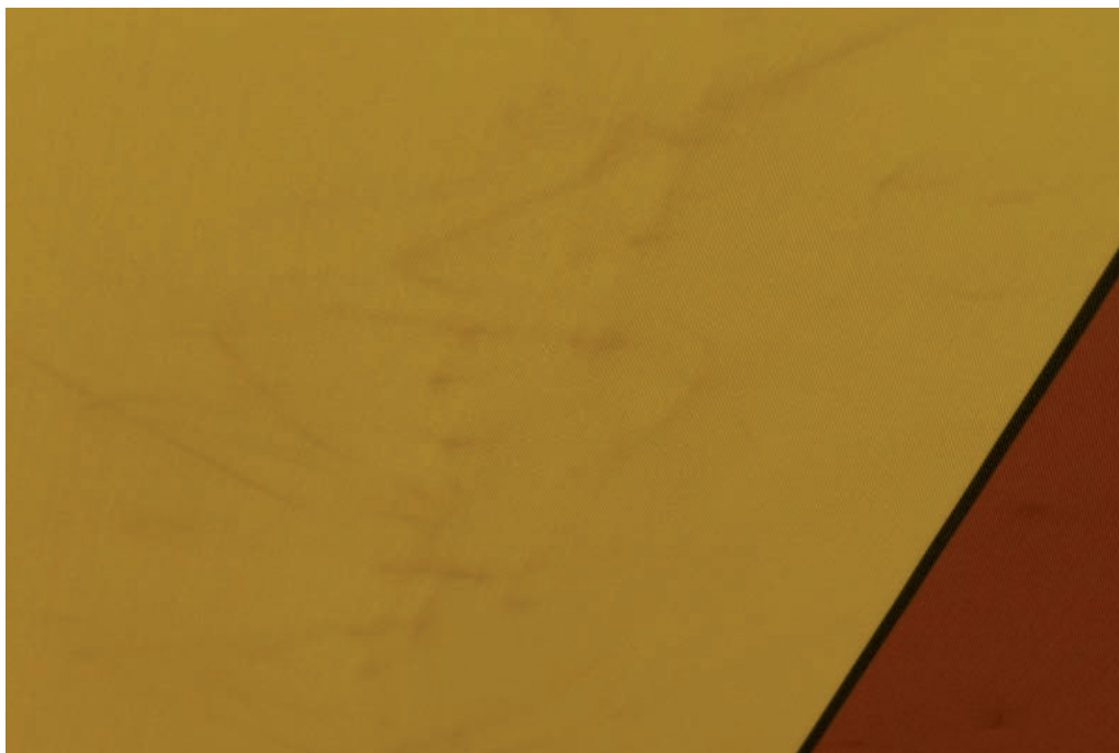
Image 9.1.17 Plis de manipulation sur les toiles de stores bannes en polyester
