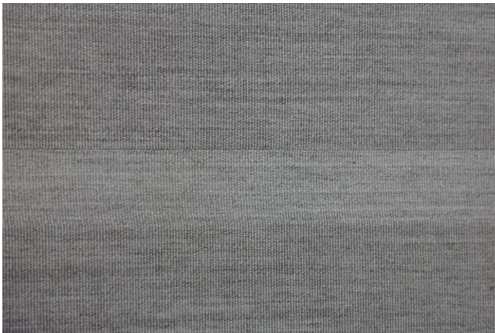
Image 9.2.1 Représentation des joints visibles pour procédé par collage
