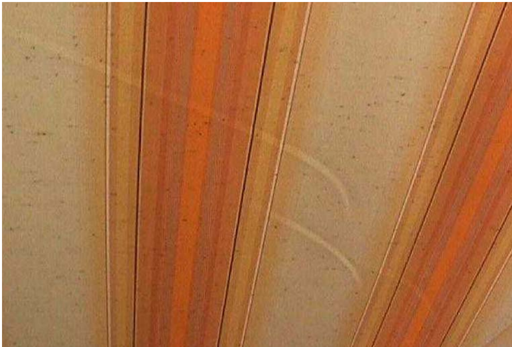
Bild 7: Darstellung von Überlagerung von Wickelfalten
