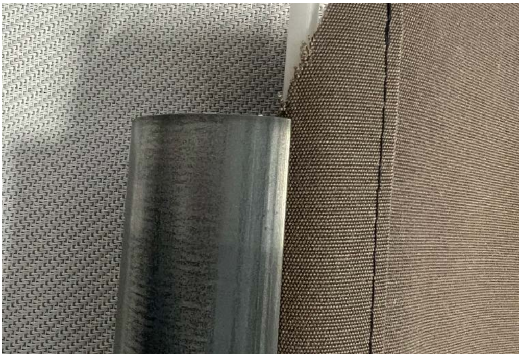
Bild 38: Eingesetzten Keder auf der Tuchwelle
