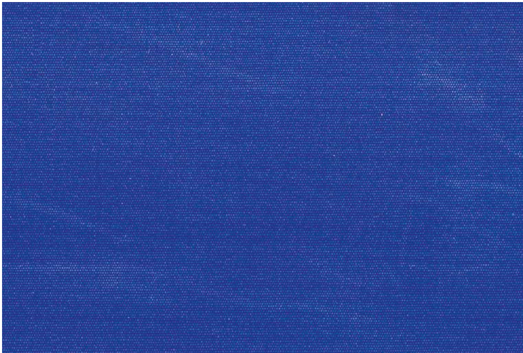
Bild 9: Kreide- und Schreibeffekt, Ursache: Helle Streifen des Imprägniermittels auf der Gewebeoberfläche
