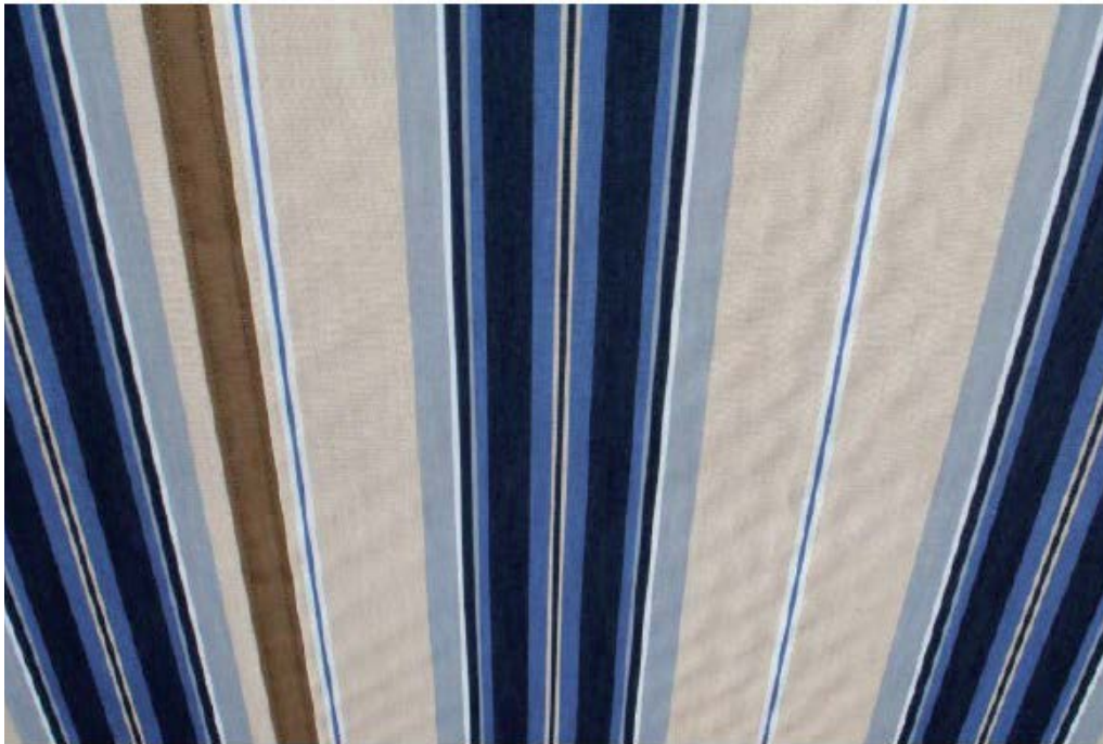
Bild 14: Welligkeit im Bahnbereich (Wabenbildung)
