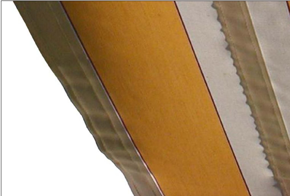
Bild 33: Welligkeit und Überdehnung im Saumbereich
