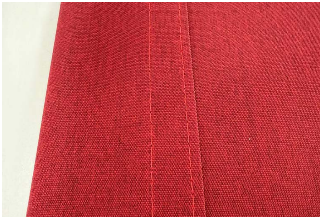
Bild 32: Seitensaum genäht 70 mm
