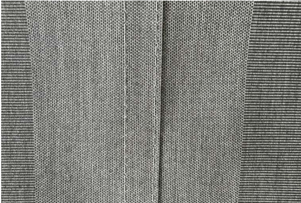
Bild 29: Beispiel einer überlappenden Mittelnaht, genäht
