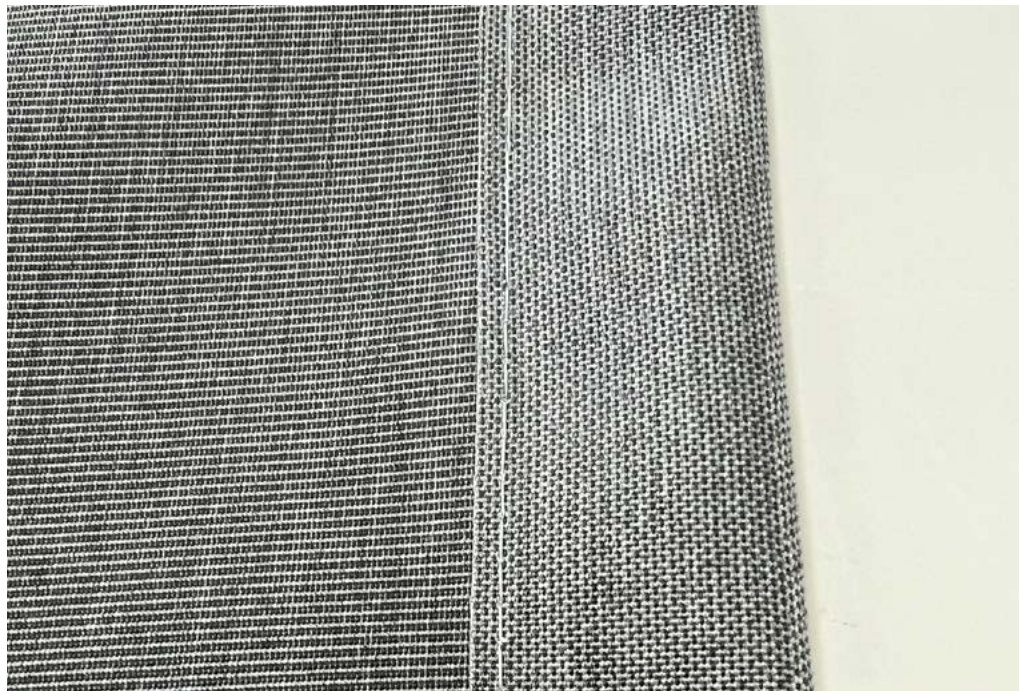
Bild 31: Seitensaum genäht 30 mm
