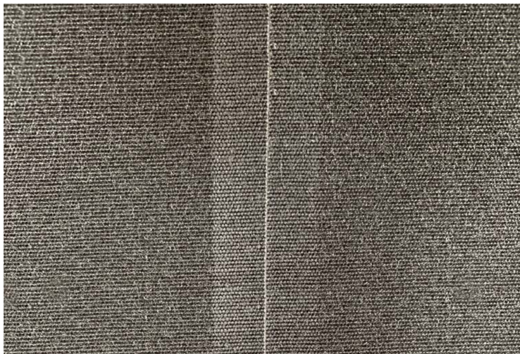
Bild 20: Auf Stoß geklebtes Tuch (Ober- und Unterseite)
