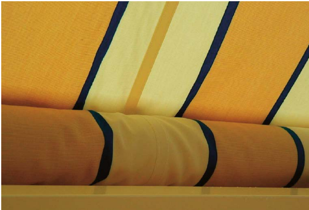
Bild 6: Stauch- und Wickelfalten auf der Tuchwelle.
