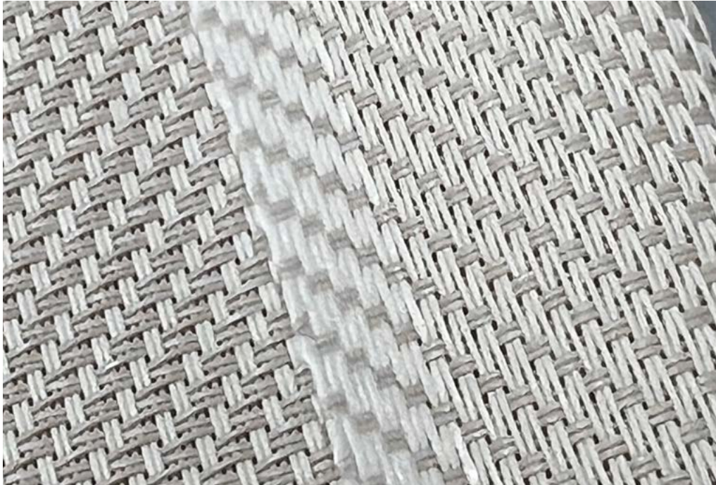
Bild 17: Typisches Bild einer Schweißnaht
