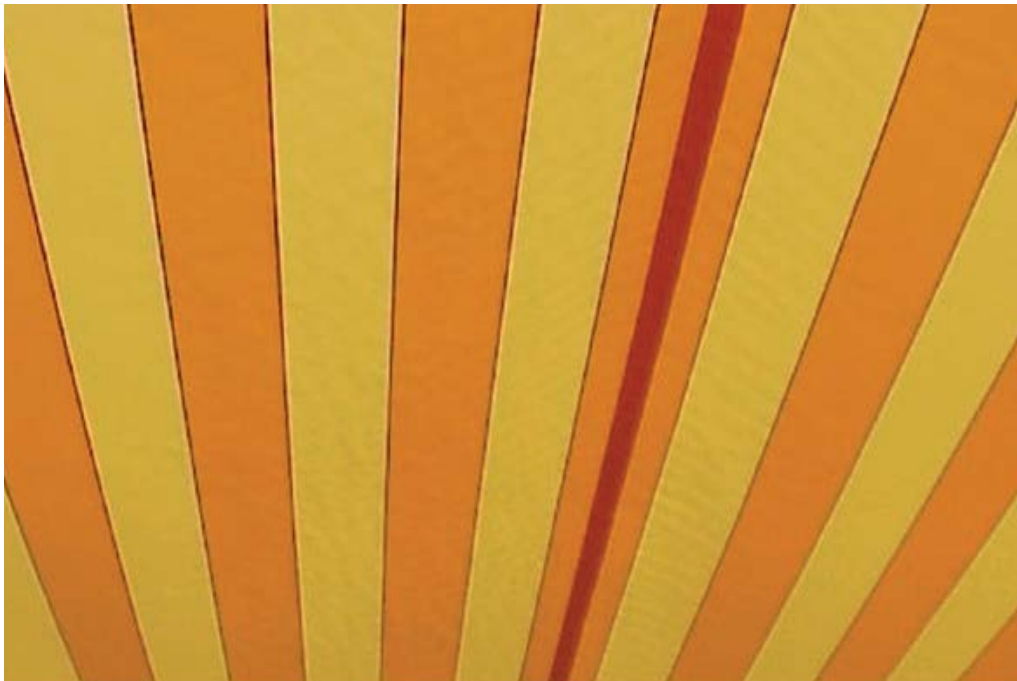
Bild 12: Welligkeit im Nahtbereich (Wabenbildung)
