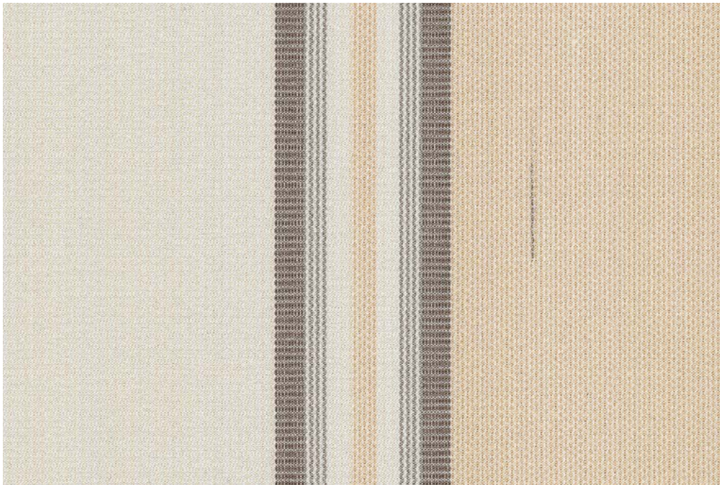
Bild 2: Eingewebte Fremdfaser, Ursache: Andersfarbige Fluse, die beim Spinn- oder Webprozess eingearbeitet wird.
