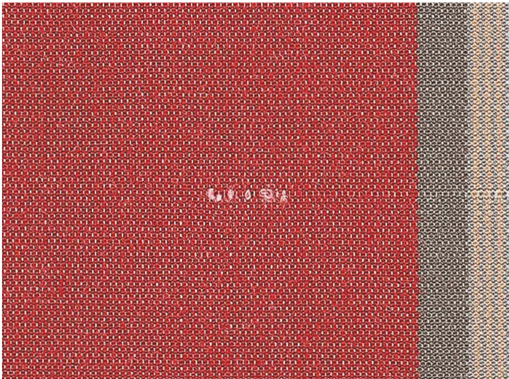
Bild 3: Dickstelle, Ursache: Dickstellen entstehen durch Anhäufen von Faserabrieb im Spinn-, Zwirn- oder Webprozess.
