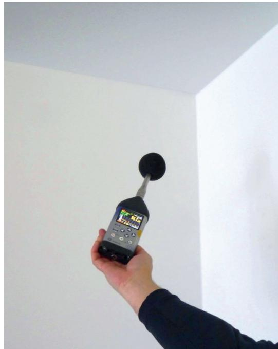
Abbildung 11: Messung des Schalldruckpegels von gebäudetechnischen Anlagen im nächstgelegenen schutzbedürftigen Raum; links: Messung in Raummitte (zwei Positionen), rechts: Messung in der Raumecke mit den akustisch härtesten Oberflächen. Anmerkung: i. d. R. werden in der Raumecke um ca. 3 dB höhere Pegel gemessen als in Raummitte.
