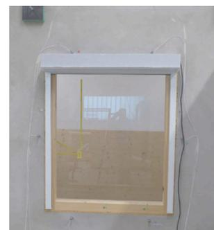
Abbildung 28: Klassischer Einbau eines Aufsatzrollladen in den Prüfstand
