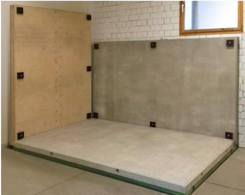
Abbildung 13: Empfangsplattenprüfstand an der HS Rosenheim
