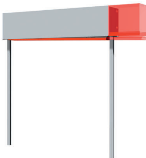
Bild 16: Veränderte Endlagenposition der Unterschiene (Unterschiene schief), Lamellenpaket einseitig sichtbar
